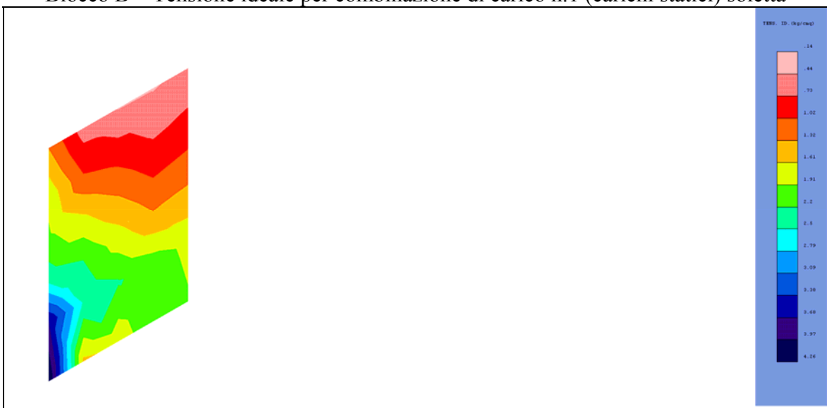
Blocco B – Tensione ideale per combinazione di carico n.1 (carichi statici) parete
